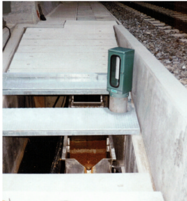
Fig 2 Chute jaugée (longueur 3 m) avec déversoire triangulaire THOMSON et limnigraphe
