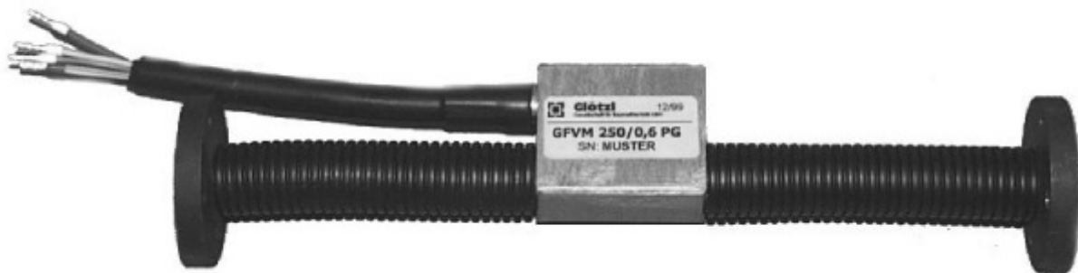
Fig 1 Capteur GFVM 250/0.5 selon le système de la corde vibrante pour les mesures d'allongement sur des éléments en béton
