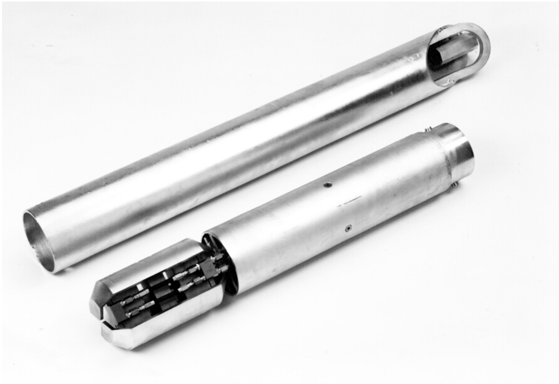
Abb. 2 Ettlinger Seitendruckgerät ESDS I/146 mit Sumpfrohr
