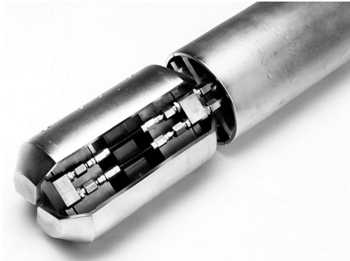
Abb. 1 Ettliger Seitendruckgerät ESDS I/146: Lastschalen, Zylinder und Wegmessgeber
